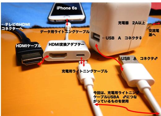
写真3 HDMI変換アダプターの接続手順。USB TypeCやサンダーボルトなどの変換アダプタもある
